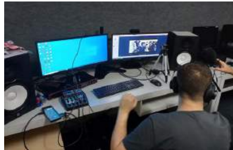
FIGURA 2. Central de equipamentos do professor: placa de áudio/ mesa de som, hub com 7 entradas, webcam sobre o monitor, microfone condensador e fone de ouvido. (Fonte: Acervo grupo de pesquisa)
