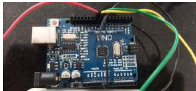
FIGURA 4. Arduino UNO, com a instalação dos Jumpers. Fonte: Própria, 2022.
